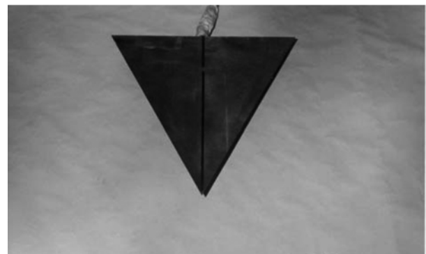
شکل (۱): مدل بال دلتا با زاویه پسگرد \Lambda = 70^\circ بکار گرفته شده در آزمایشات غلت و لغزش سمتی.
