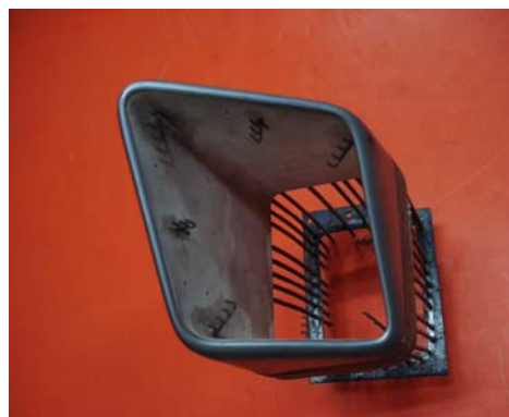
شکل (۸): نما از روبروی قطعه جدا شونده از مدل برای اندازه گیری فشار کل و فشار استاتیک در لبه ورودی دهانه.
