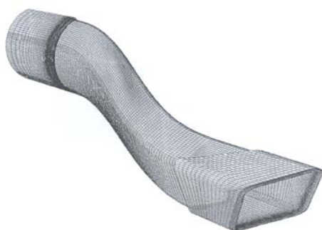
شکل (۳): نما از روبروی یکی از شاخه های مجرای ورودی هوا.
