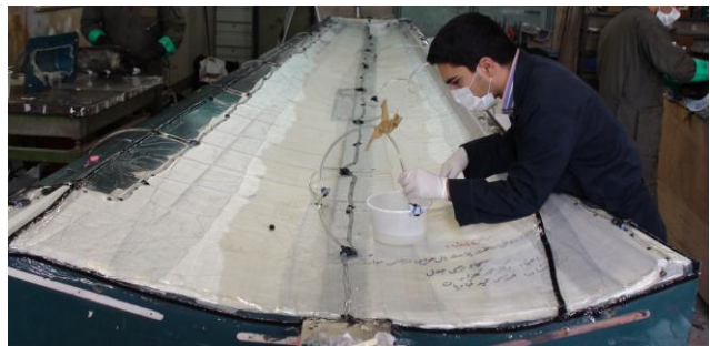
شکل (۱۰): تزریق رزین در ساخت پوسته بال ۹ متری.
